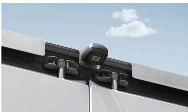
La caméra de recul peut être placée au choix sur la partie arrière du véhicule, par exemple sur la carrosserie, et surveille la zone qui se trouve derrière le véhicule.
