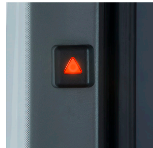
Le regard du conducteur est attiré dans la zone de danger : témoin d'alerte rouge ou jaune dans le montant A.
