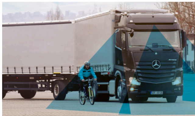
Le système peut aider le conducteur lors des virages, de la marche arrière et des manoeuvres de virage et améliorer sa sécurité.
