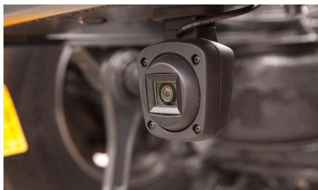
Vue panoramique pour le conducteur : le système SurroundView peut également couvrir la partie latérale du véhicule. Jusqu'à quatre caméras peuvent être raccordées au moniteur.
