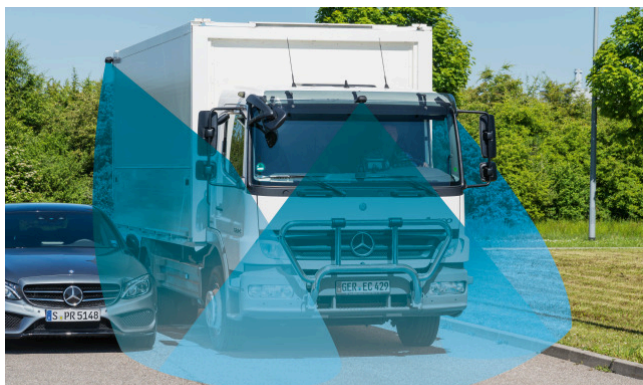
Le système modulaire SurroundView rassemble des vues de l'environnement sur un moniteur, permettant ainsi de voir les angles morts.
